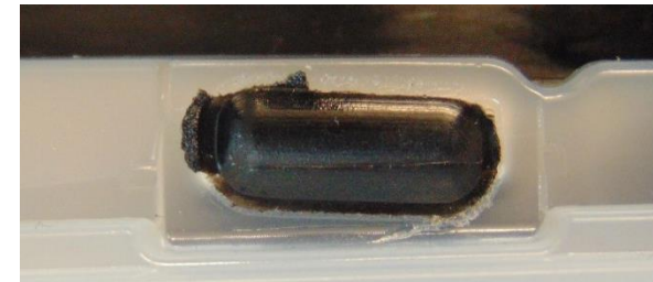
Schweißergebnis mit Beschichtung – Weld result coated
