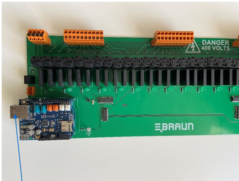
Schnittstelle zur Basissteuerung
