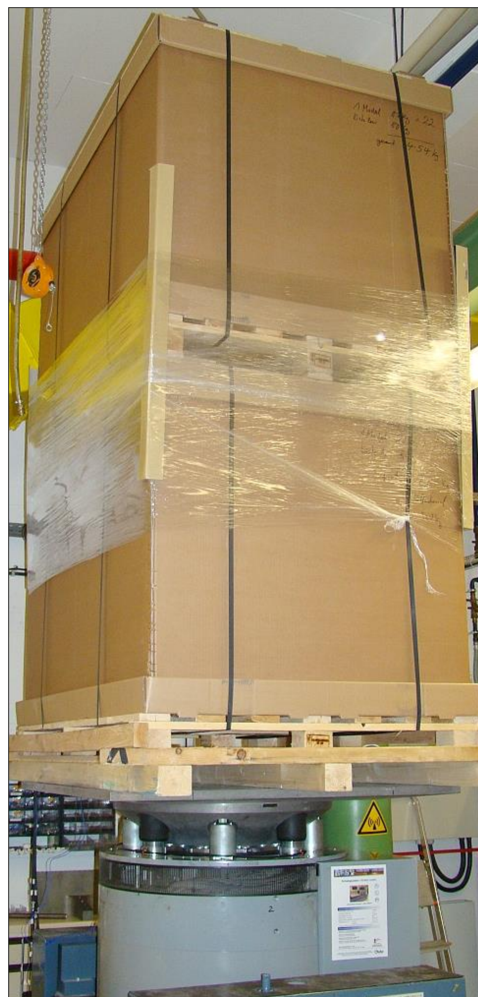
Vibrations- und Schockprüfung zur Simulation von Schwingungen- und stößen auf Ladeflächen unterschiedlicher Transportmittel
