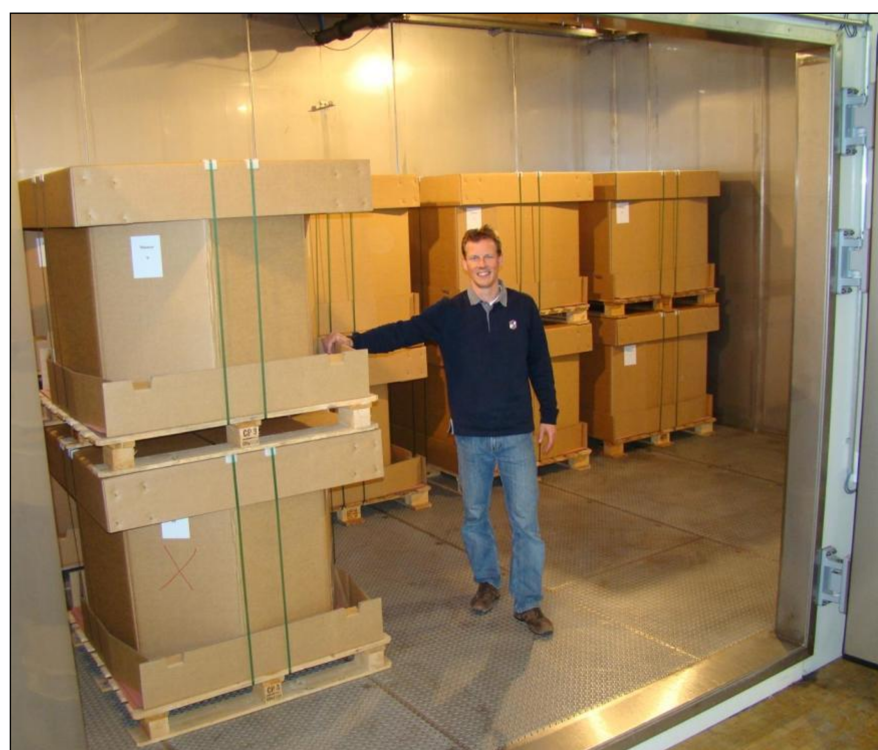
Vorkonditionierung von Ladeeinheiten in der begehbaren Klimaprüfkammer
