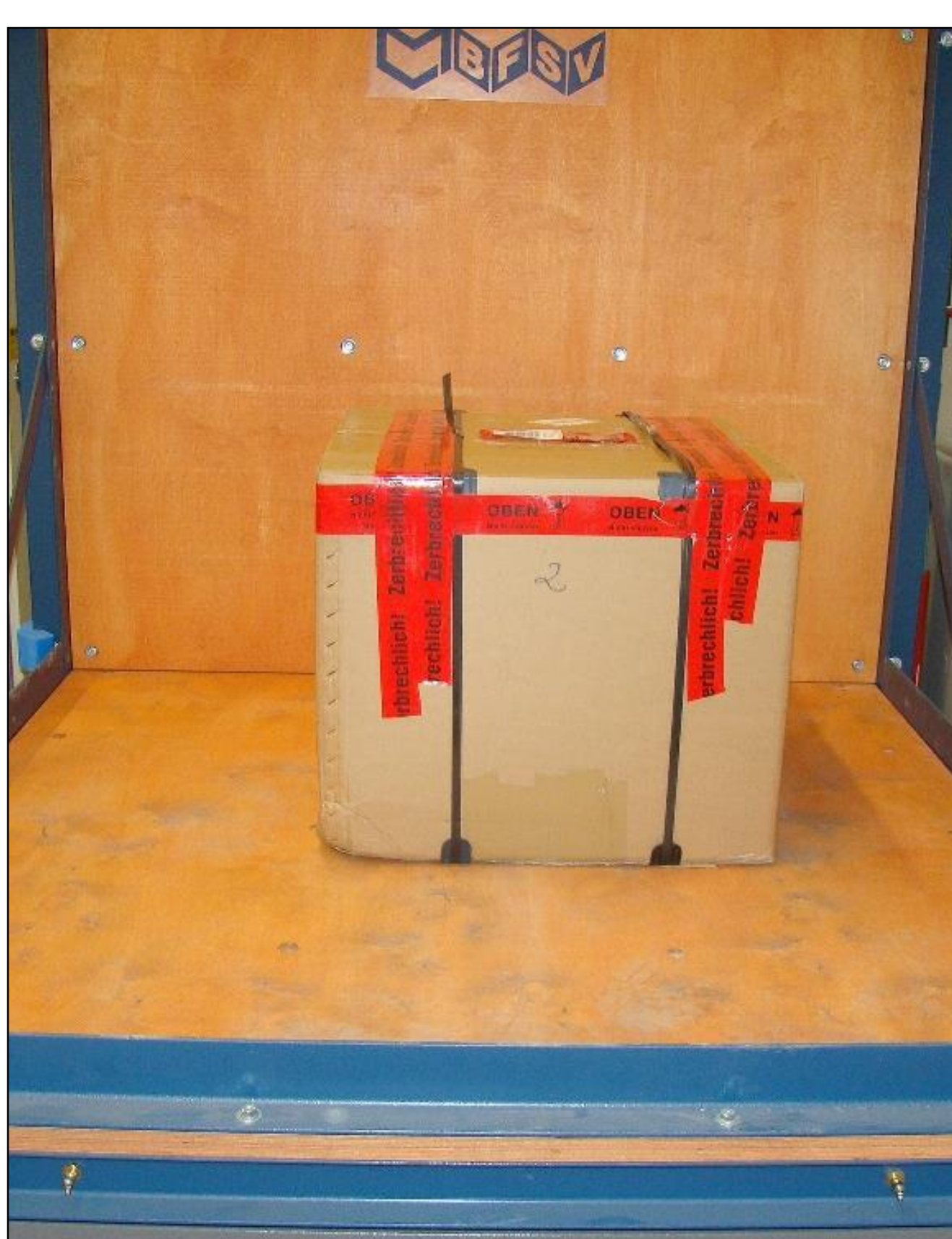
Prellprüfung zur Simulation von Stößen beim Transport
