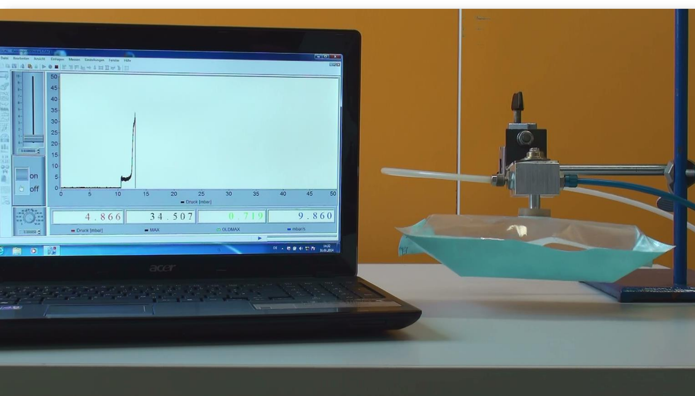
Ermittlung des Innendruckwiderstandes mittels Burst- und Creep-Test nach ASTM F1140
