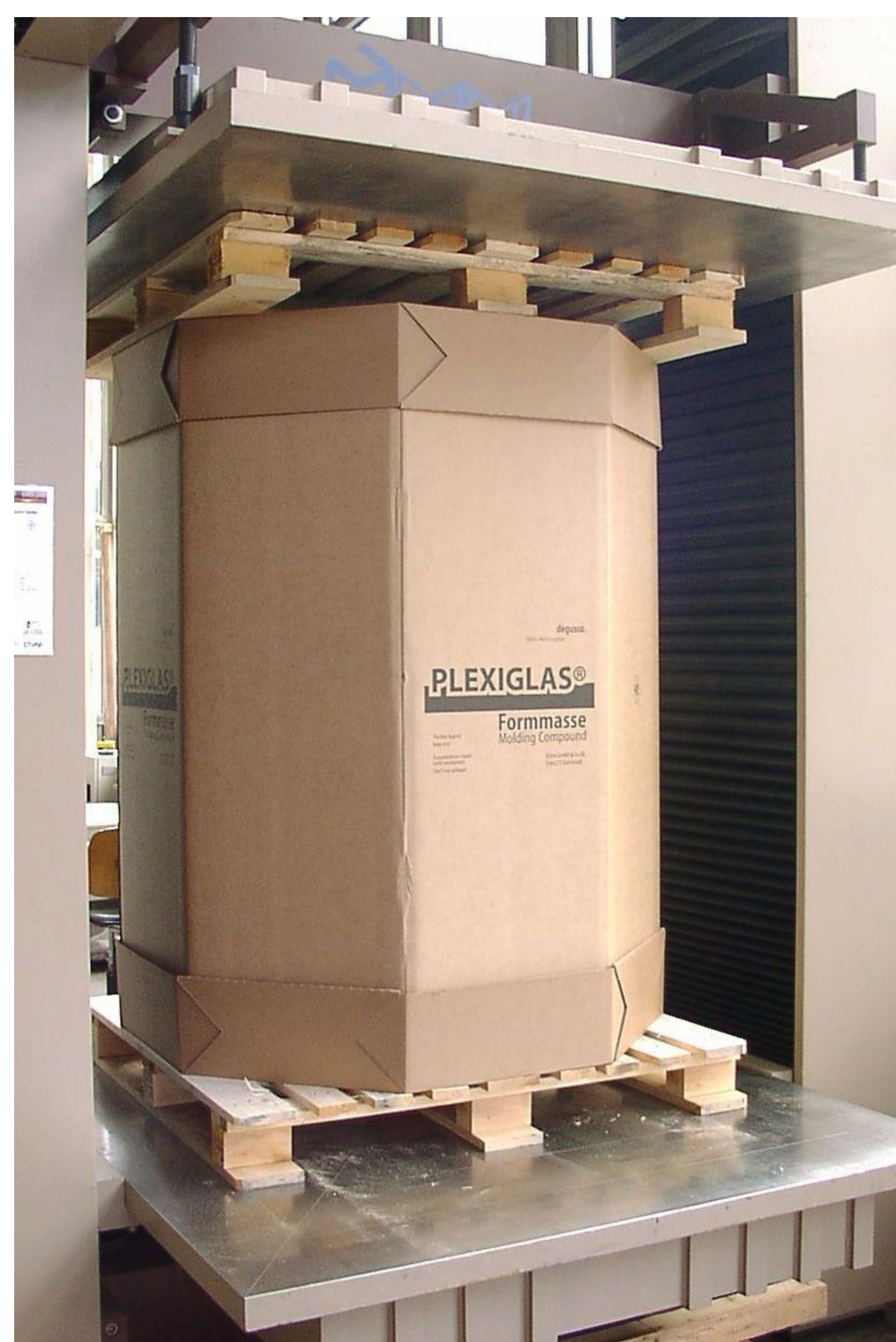
Stauchprüfung zur Ermittlung der Tragfähigkeit bei Transport und Lagerung
