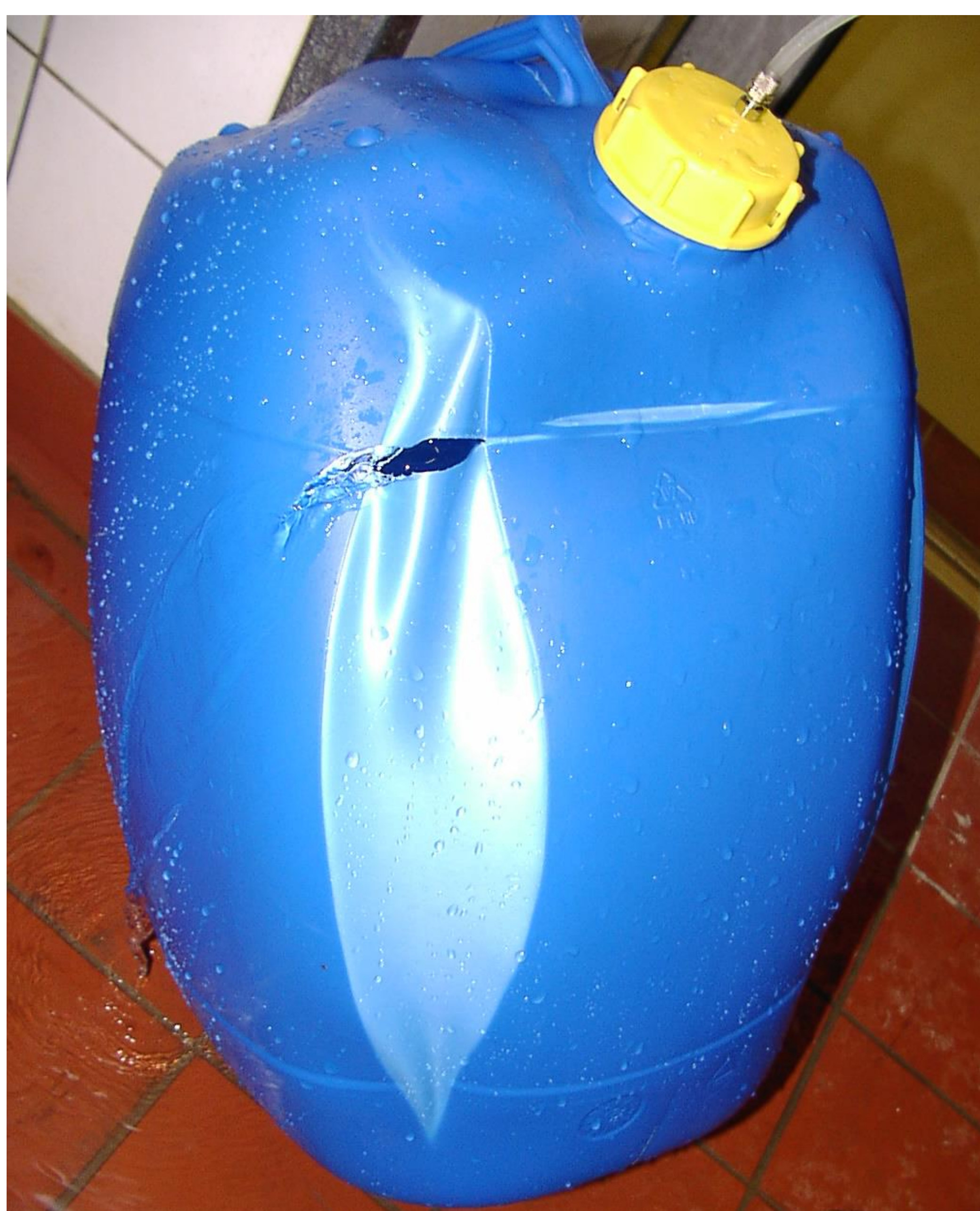
Innendruckprüfung an Kunststoffkanistern
