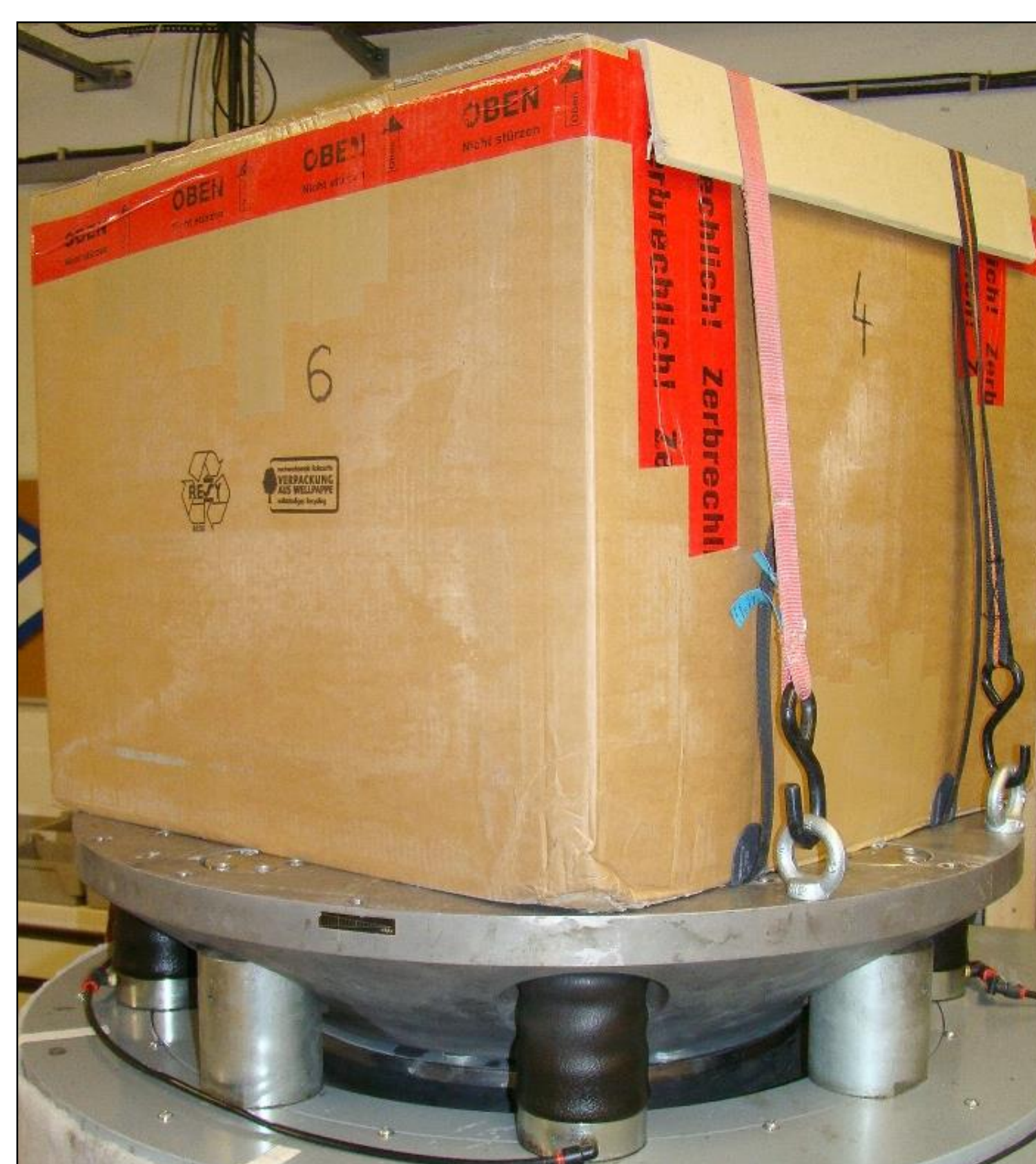
Vibrations- und Schockprüfung zur Simulation von Schwingungen- und stößen auf Ladeflächen unterschiedlicher Transportmittel
