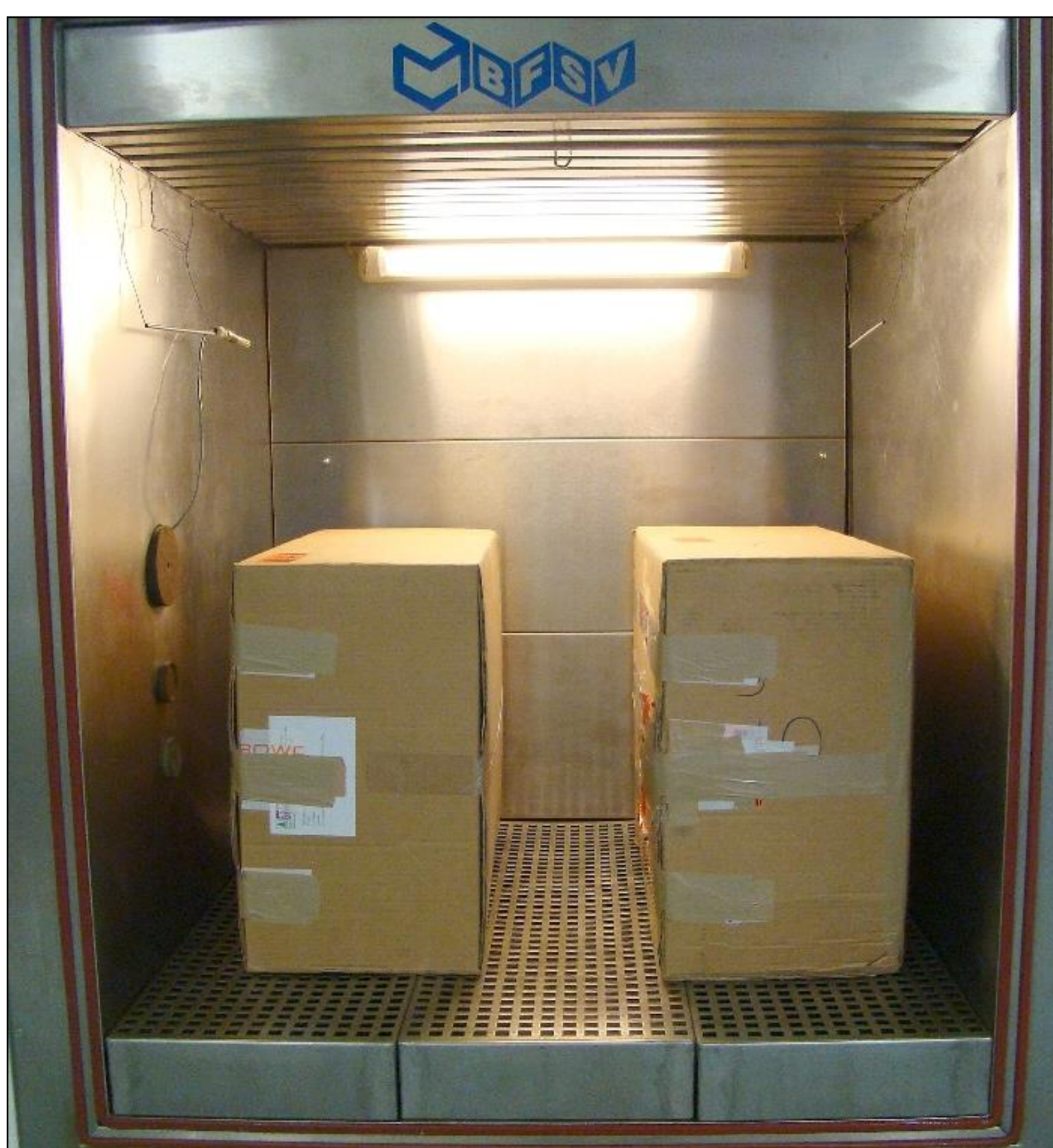
Vorkonditionierung von Packstücken in der Klimaprüfkammer
