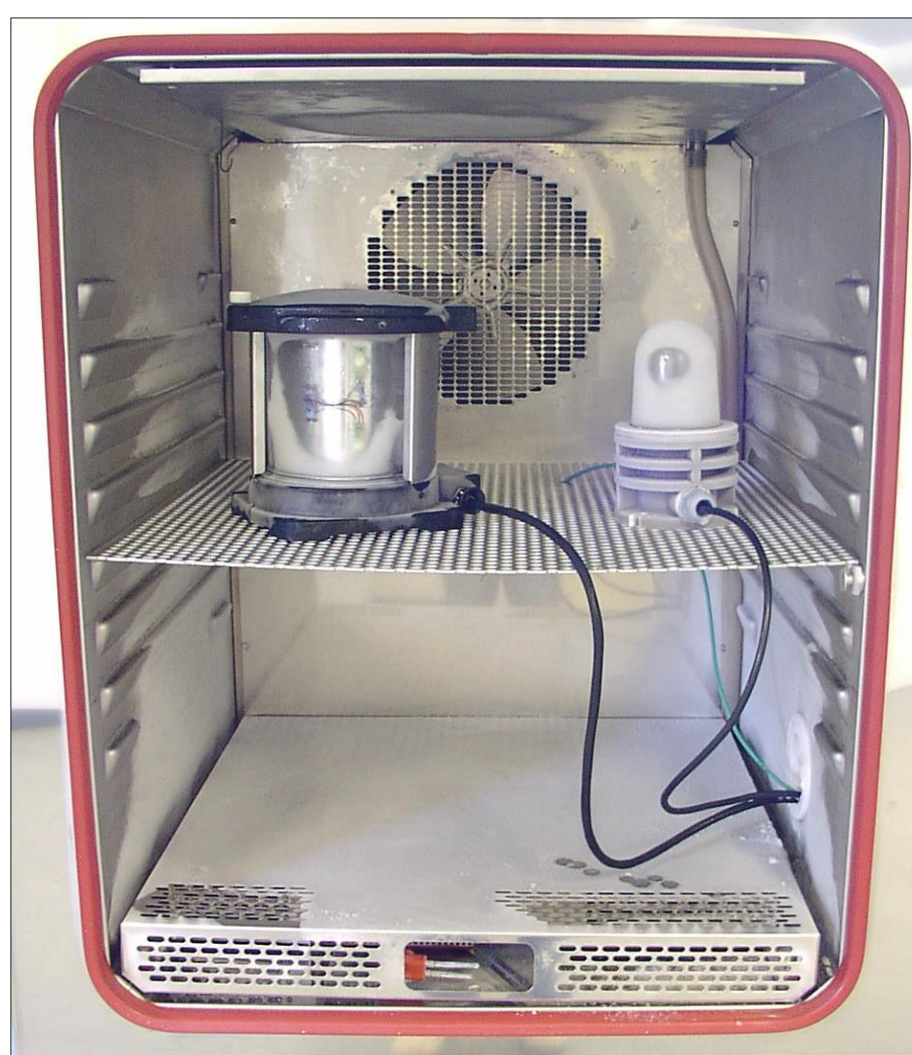
Funktionsüberprüfung von Leuchten nach Kälteprüfung
