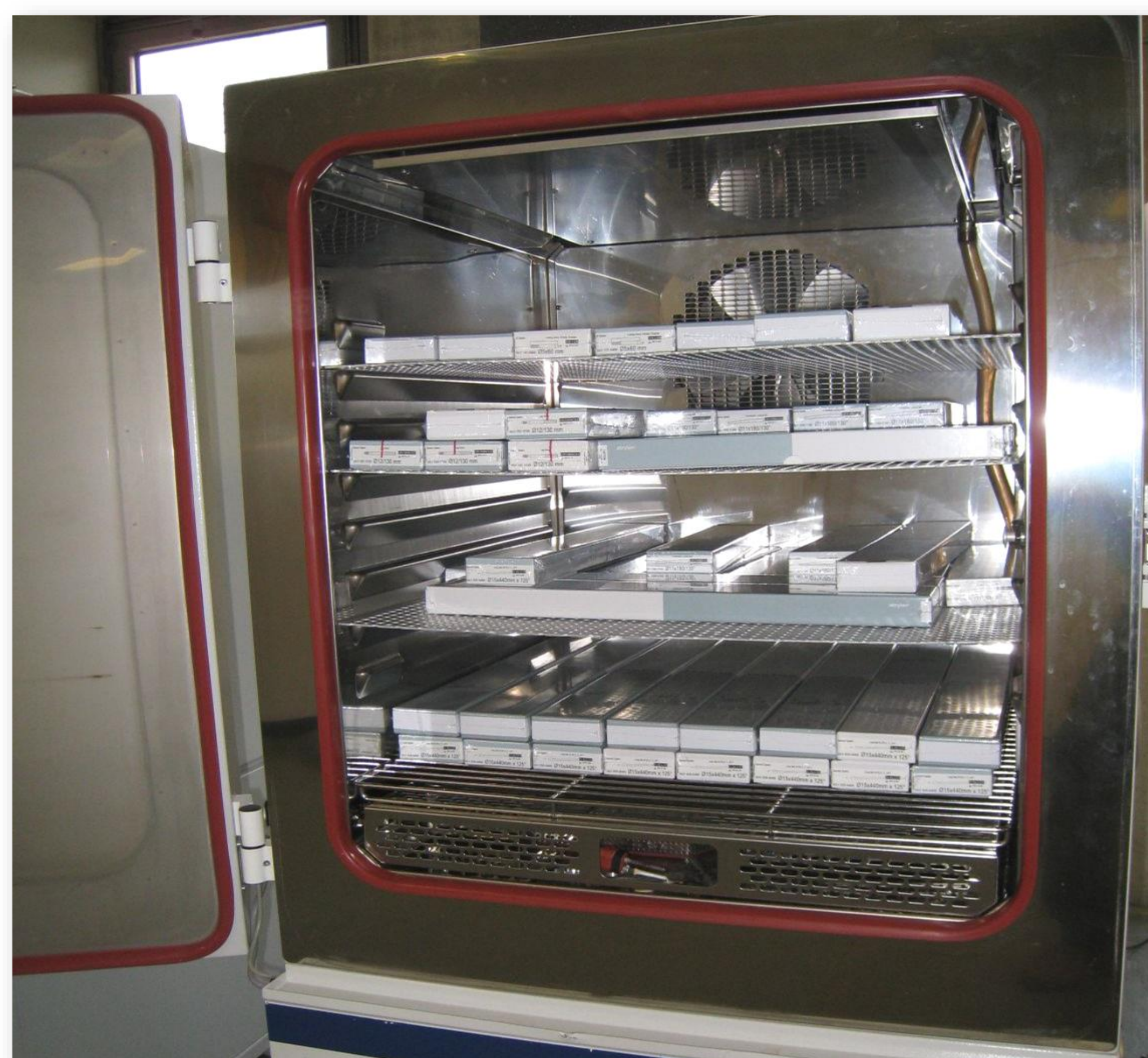
Beschleunigte Alterung nach ASTM F1980
