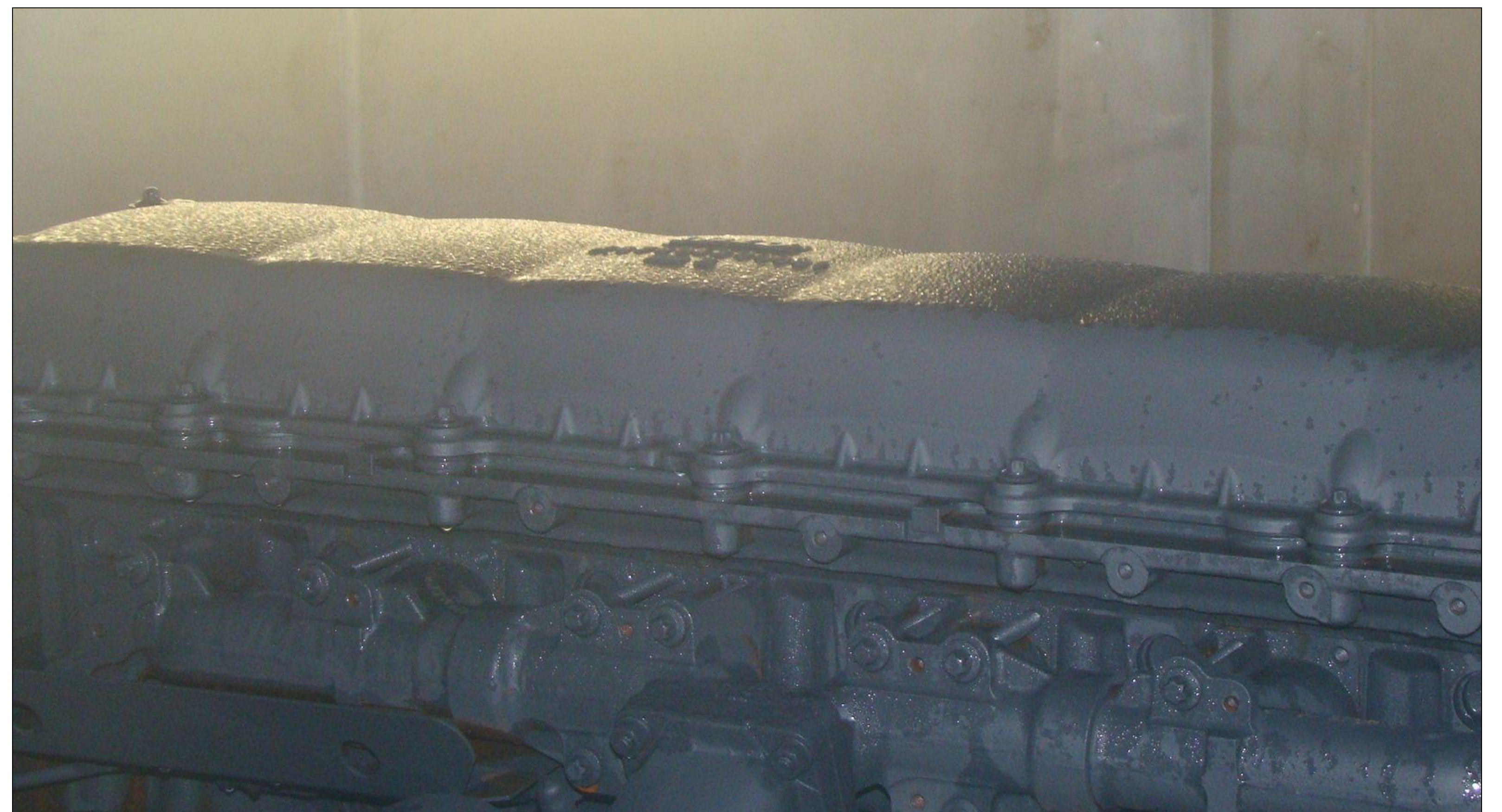
Betauung der Oberfläche eines Motors während einer Klimawechselprüfung zur Simulation von Klimabelastungen eines Übersee-Versandes
