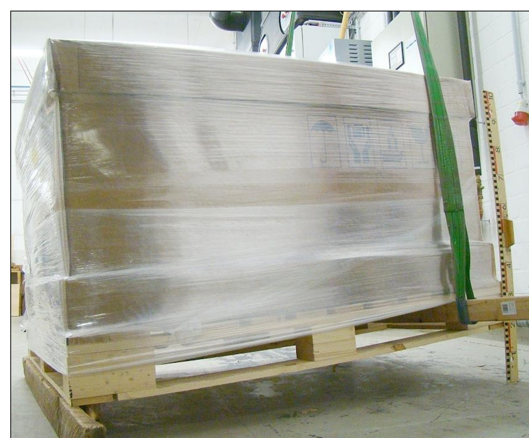
Kippfallprüfung zur Simulation von Stoßbelastungen während des Umschlags
