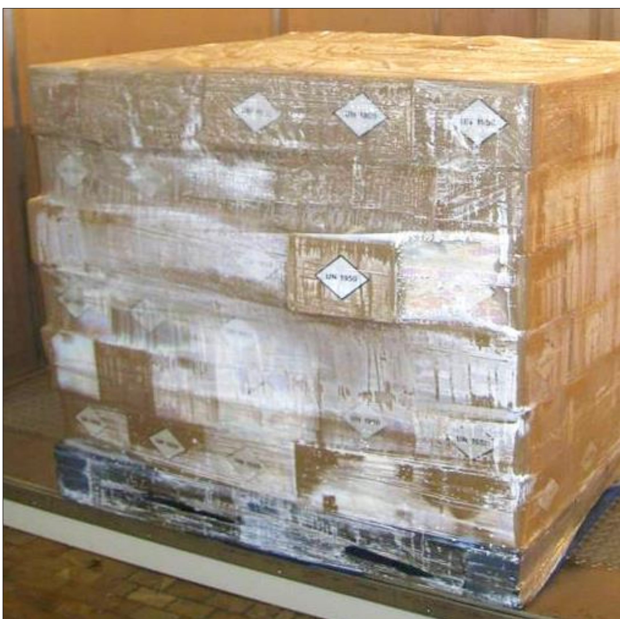
Kondensation von Luftfeuchte unter Stretchfolie nach extremer klimatischer Belastung
