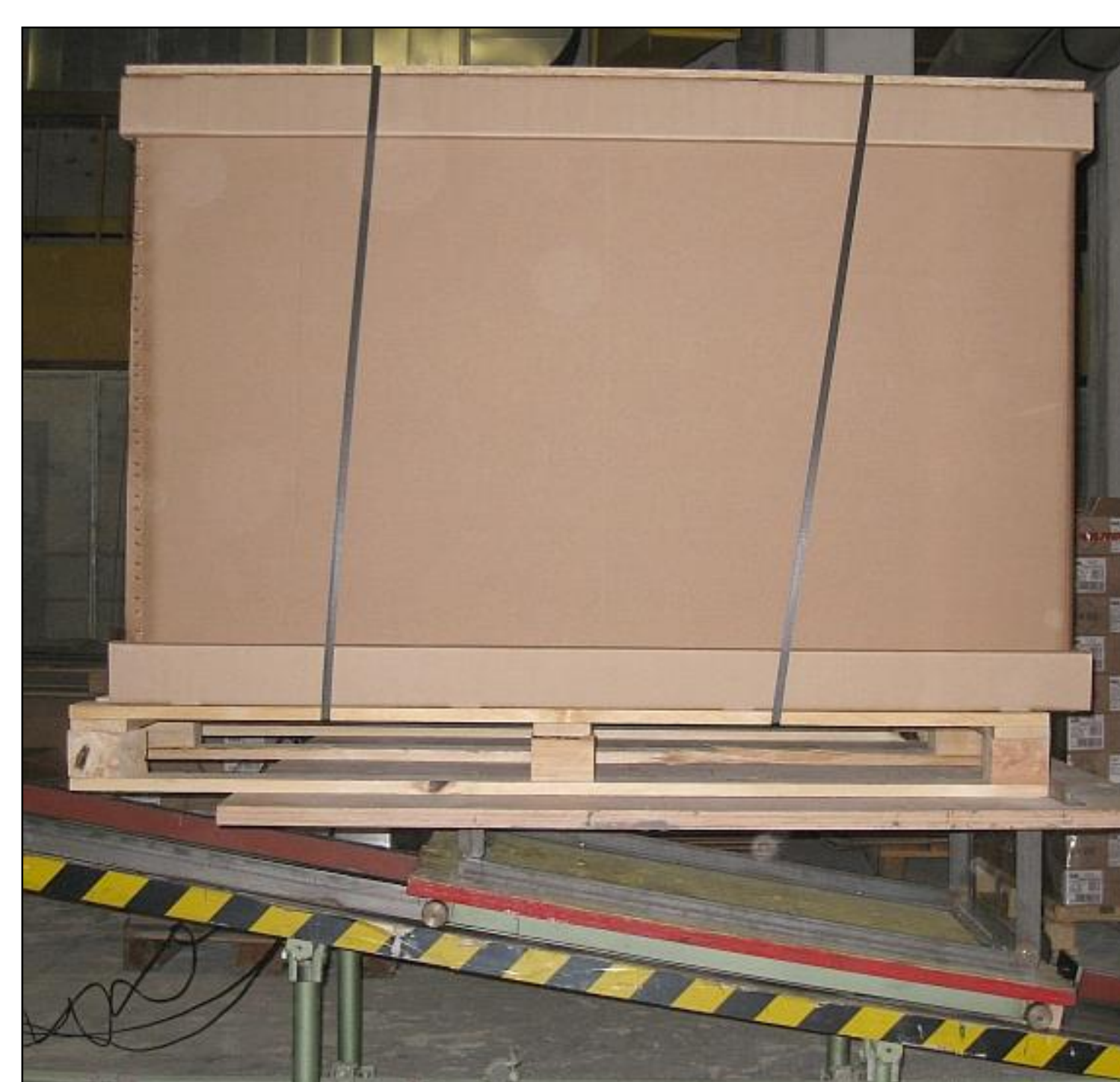
Bremssprüfung auf der Schiefen Ebene zur Überprüfung des Verbundes von Ladung und Ladungsträger
