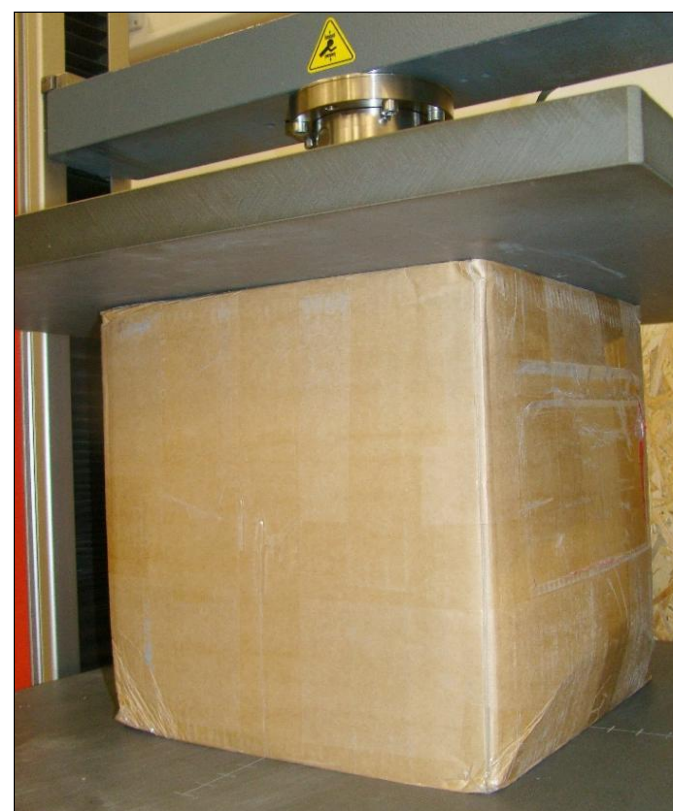
Stauchdruckprüfung zur Simulation von Druckbelastungen während der Lagerung
