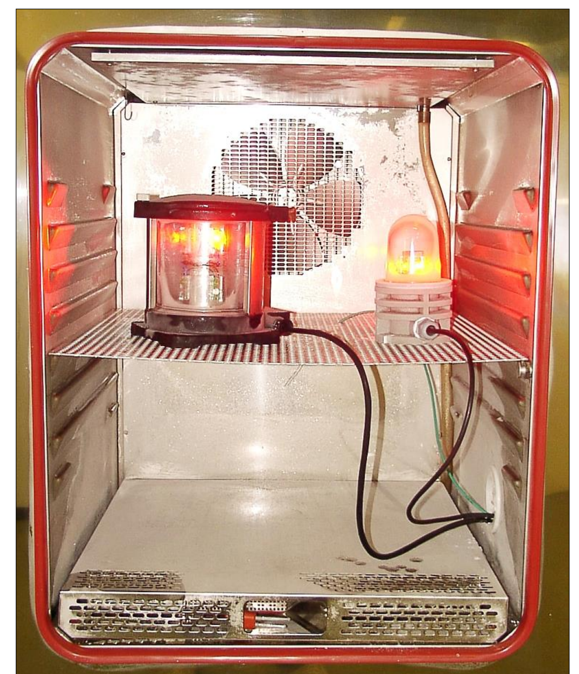
Funktionsüberprüfung von Leuchten nach Kälteprüfung
