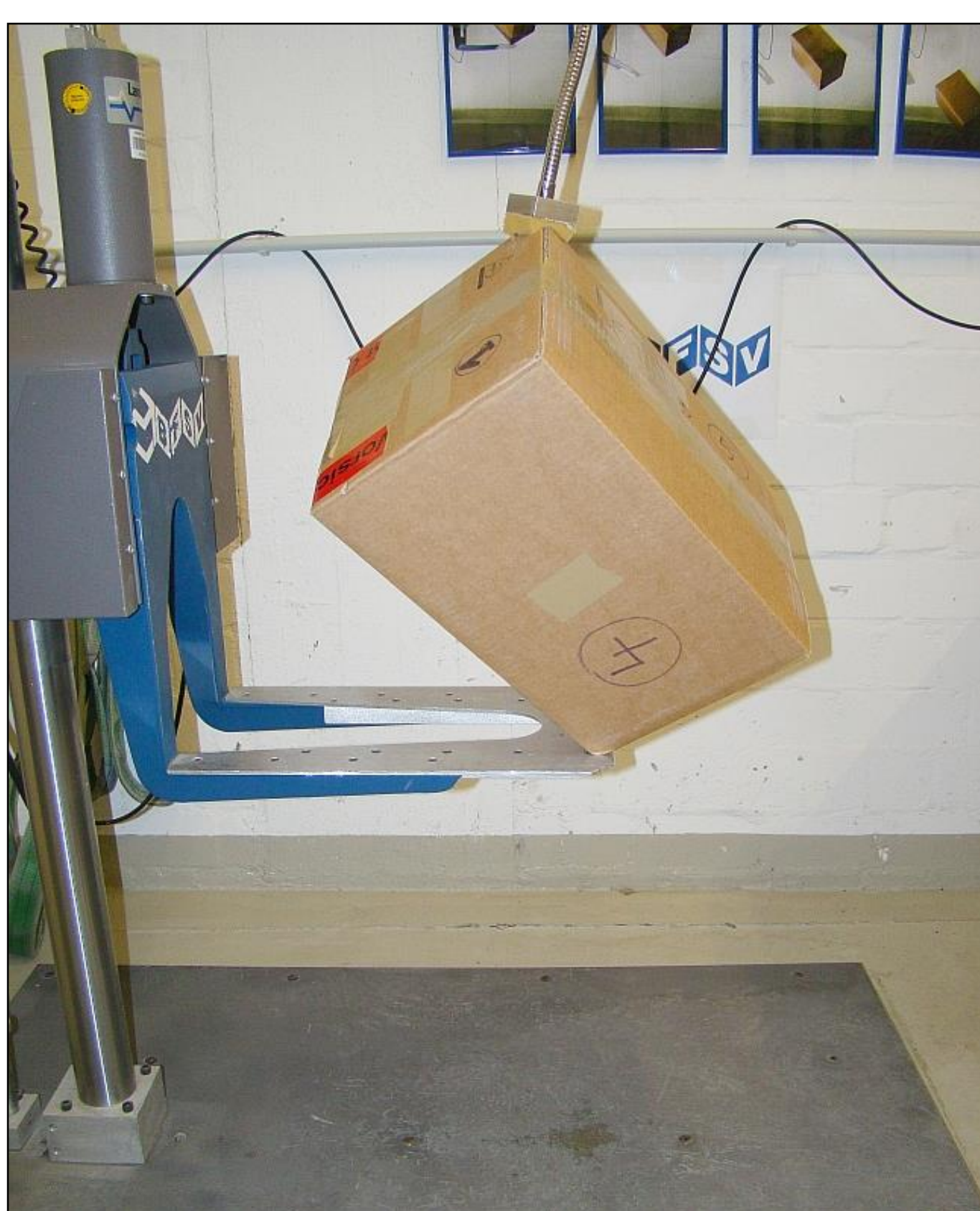
Fallprüfung auf eine Ecke des Packstücks mit optionaler Beschleunigungsmessung am Packgut
