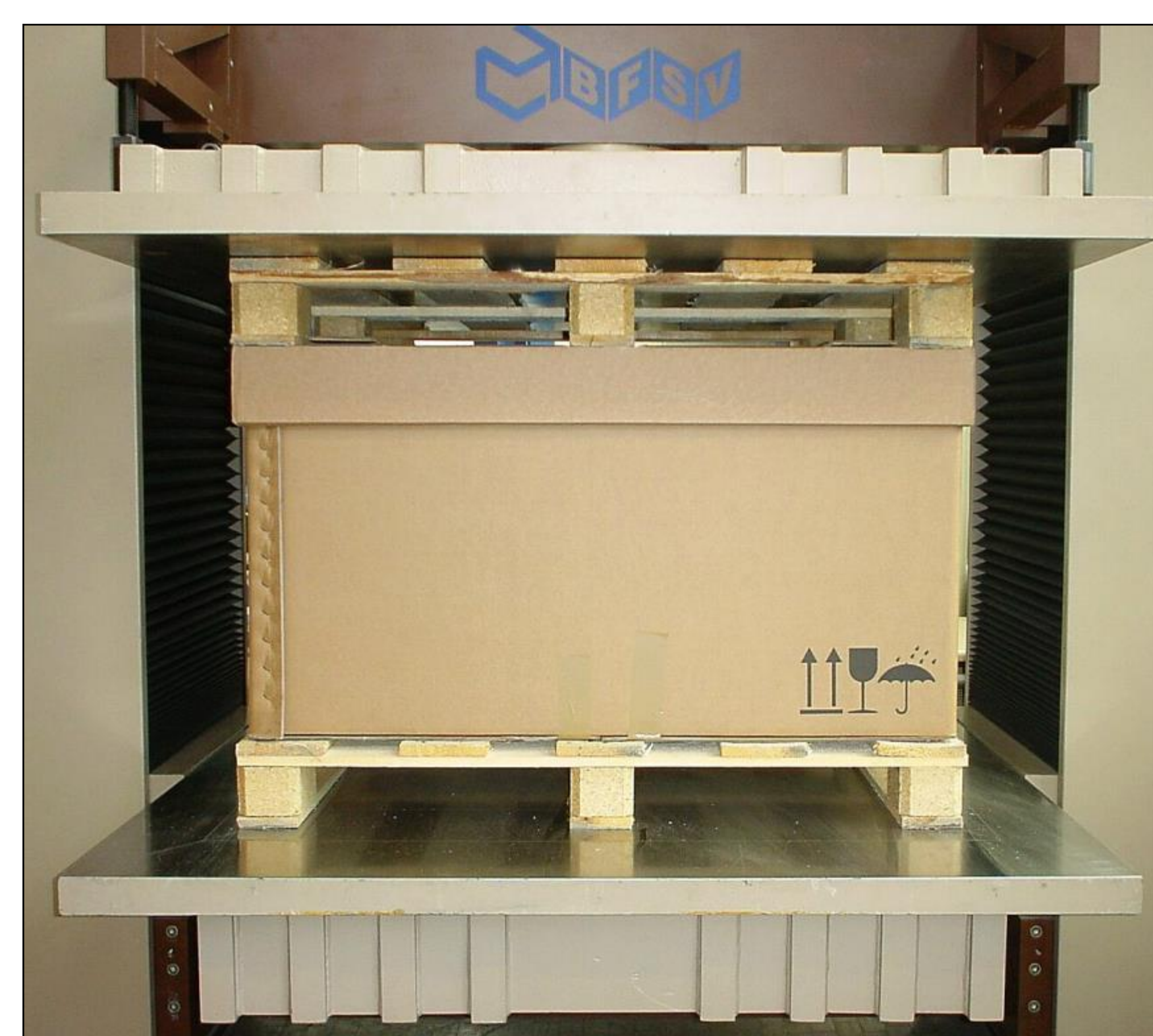
Stauchdruckprüfung zur Simulation von Druckbelastungen während der Lagerung
