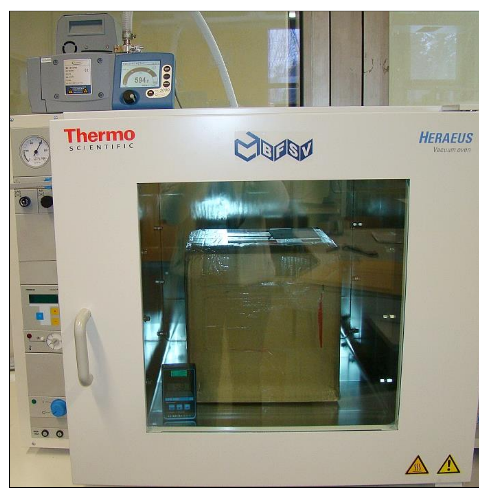
Unterdruckprüfung zur Simulation von red. Umgebungsdruck im Luftfrachtverkehr
